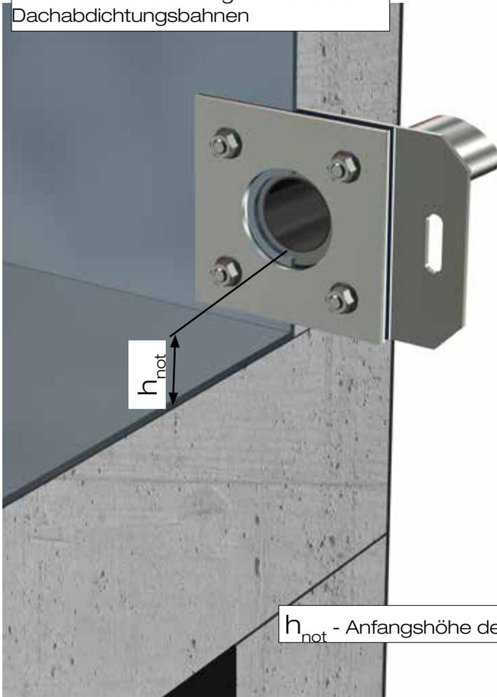
Bild 2 Balkonabdichtung mit Bitumen-Dachabdichtungsbahnen
